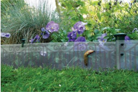
Bei unserem Produkt "Slugs away" ist der komplette Zaun elektrisch leitend. Die obere und untere Hälften des Zauns entsprechen den beiden leitenden Drähten und sind nur durch eine dünne Isolation getrennt. **Deshalb können auch kleinere Schnecken hier nicht passieren.**
