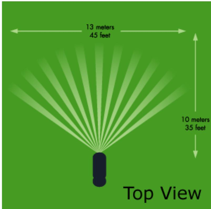
Bei tiefen Temperaturen, ist die Reichweite grösser. Bei hohen Temperaturen oder direkter Sonneneinstrahlung kann die Reichweite reduziert sein. Dies basiert auf dem [Funktionsprinzip des Sensors](#) und ist kein Fehler.
