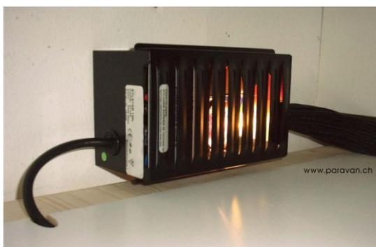
Beispiel einer montierten "Lampen-Bar" links der Stromanschlüsse, rechts das Faserbündel, das sich zur Montage von der Box trennen lässt.
